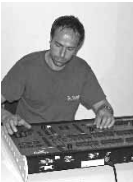
Das Lichtmischpult mit 48 Steuerkanälen ermöglicht die Einstellung einer Vielzahl von Lichtstimmungen.
