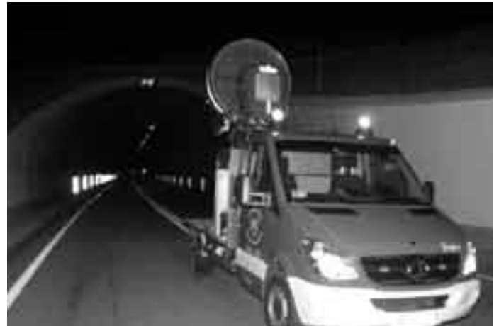
Entrauchung durch den neuen Großraumventilator der FF Naturns.
